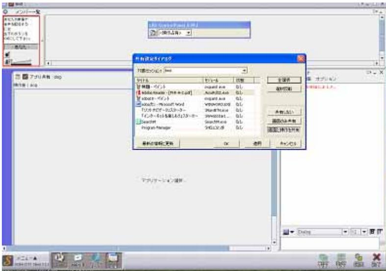
上の面に最初左にある<操作占有>の表示が出る。他人に操作権を渡すときはここをクリックして操作する。また、「共有設定ダイアログ」が出て自分が表示したいタイトルをクリックして、例えば、「画面のみを共有」をクリックすると、「OK」「適用」などが
